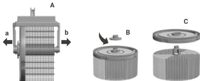
**2.** Maak de bevestigingsarmen a en b voorzichtig los van de as en verwijder drager A van de verdamperrol.
