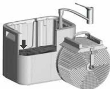
Riempire la vaschetta dell'acqua nella parte inferiore dell'apparecchio con acqua corrente (ca. 9 litri) fino alla metà dell'unità di evaporazione.
