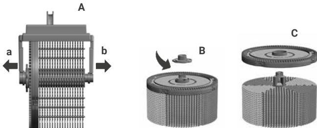
2. Осторожно снимите удерживающие рычаги а и b с оси и снимите держатель А с испарительного ролика.
