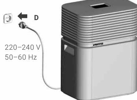
Csatlakoztassa a hálózati csatlakozódot **D**, majd kapcsolja be a készüléket a Power gomb **④** rövid megérintésével.
