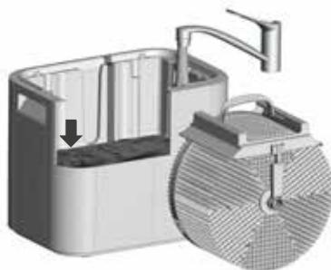
Vul de waterbak in het onderste deel van het apparaat met vers leidingwater (ca. 9 liter), maximaal tot de helft.
