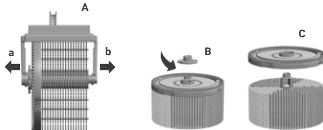
2. Opatrne uvoľnite prídržné ramená a a b z osi a odstráňte nosník A z valca odparovača.
