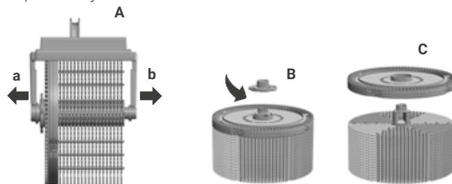
**2.** Upevnovací ramena (a) a (b) opatrně uvolněte z osy a z odpařovacího válce odstraňte nosič A.
