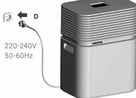
Brancher la fiche secteur **D** sur le secteur et allumer l'appareil en appuyant brièvement sur le bouton marche/arrêt **④**.
