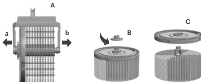
2. Haltearme a und b vorsichtig von Achse lösen und Träger A von Verdunsterwalze entfernen.
