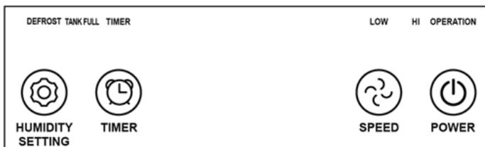
**POWER** - Naciśnij ten przycisk, aby włączyć lub wyłączyć urządzenie.
