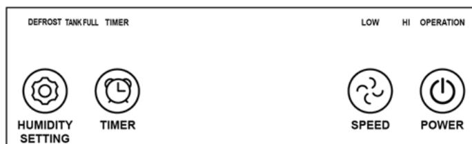
POWER - Druk op deze knop om het toestel aan of uit te zetten.
