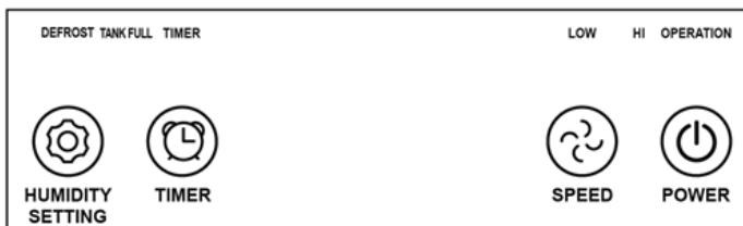
POWER - Stlačením tohto tlačidla zapnete alebo vypnete jednotku.
