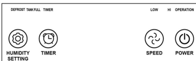
**POWER (GÜÇ)** - Üniteyi açmak veya kapatmak için bu düğmeye basın.
