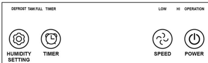
POWER - Stisknutím tohoto tlačítka zapnete nebo vypnete přístroj.
