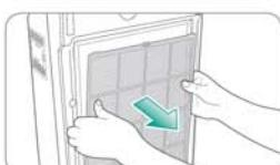
3. Čistěte předfiltr vysavačem nebo vodou v závislosti na stupni znečištění.
