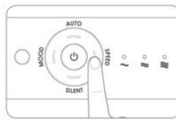
4. Po nastavení je vnímavost senzoru znečištění stanovena, když je tlačítko výkonu stisknuto tak, aby byl přístroj vypnut, nebo automaticky nastaven, když uplynulo 20 sekund v nastaveném režimu.
