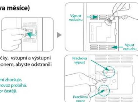
Lehce navlhčete bavlněný tampon a vycistěte čočky, vstupní a výstupní otvor prachu. Ořete je suchým bavlněným tamponem, abyste odstranili přetrvávající vlhkost.
