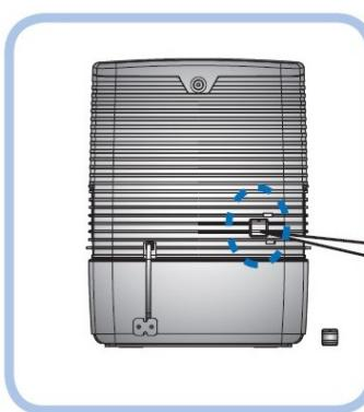
Prachový senzor vyčistěte pomocí tyčinky s vatou. Pokud je čištění problematické, pak můžete vatovou tyčinku lehce navlhčit, avšak poté je třeba senzor vysušit suchou vatou.
