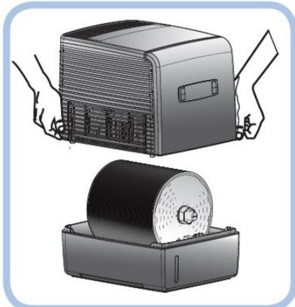
Jestliže jsou HEPA filtry znečištěny je nutné je vyměnit, proto postupujte dle následujících instrukcí.
