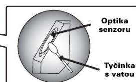
Nepoužívejte k čištění alkohol či jiné chemické látky neboť může dojít k poškození prachového senzoru. Po skončení vraťte kryt prachového senzoru na původní místo.
