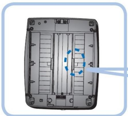
Otočte horní díl přístroje a ze zajišťovacího mechanismu vyjměte HEPA filtry.
