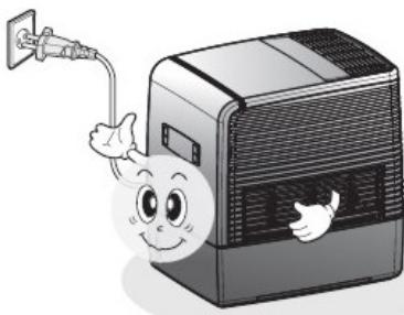
Horní díl přístroje neomývejte vodou, ale pouze navlhčeným hadříkem. V opačném případě může dojít k poškození přístroje nebo můžete utrpět zásah proudem. Vnitřní a vnější části čistěte vlhkým hadříkem.
