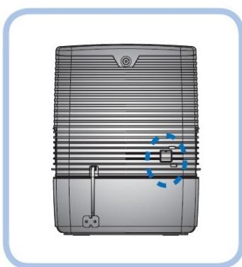
Doporučujeme provádět čištění prachového senzoru minimálně jednou za půl roku. Jestliže je okolní prostředí silně znečištěno, pak je nutné provádět tuto činnost častěji.
