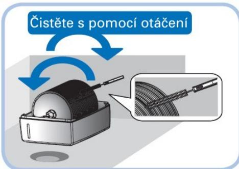
Nádobu na vodu naplňte vodou s čistícím prostředkem po značku max. hladiny vody. S pomocí otáčení a kartáče, který je součástí příslušenství očistěte rotující válec.
